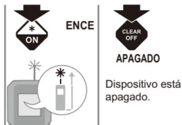
**i** Si no se pulsa ninguna tecla en 120 seg, el dispositivo se apaga automáticamente.
