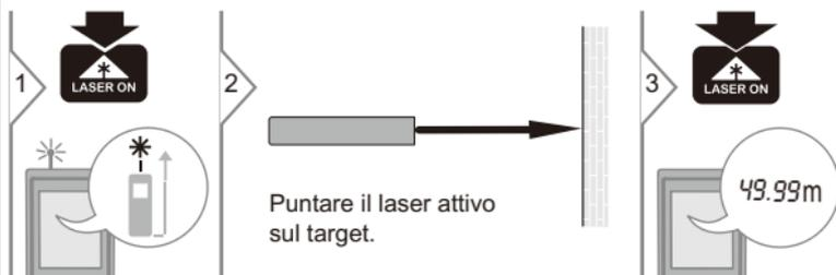
**i** Superfici target: se si misura la distanza da liquidi incolore, vetro, polistirolo o superfici semipermeabili o si punta su superfici molto lucide possono verificarsi errori di misura. In presenza di superfici scure il tempo di misura può aumentare.
