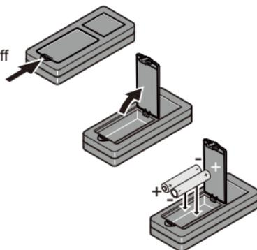
Sostituire le batterie quando il simbolo appare vuoto.
